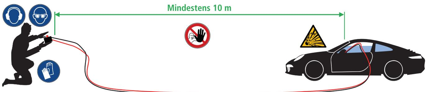
Abbildung 3: Schutzmaßnahmen beim Auslösen (Vernichten) eines Fahrerairbags im eingebauten Zustand (Quelle: ZDK)
